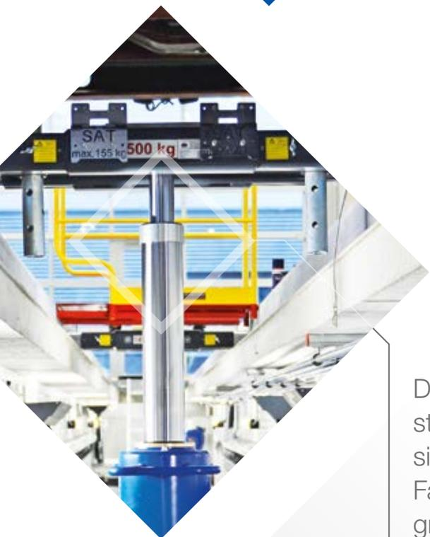
Druckluftantrieb beim Absenken in beiden Teleskopstufen erhöht die Senkgeschwindigkeit in die Grundposition und vermeidet somit ungewollte Kollisionen des Fahrzeuges beim Abfahren von der Arbeitsgrube, aufgrund der immer zurückfahrenden Kolbenstange
